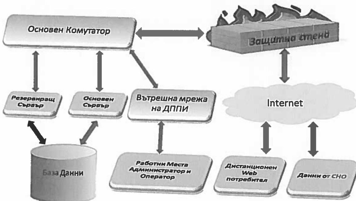
Архитектурата на системата е изградена на базата на два сървъра за работа на приложният софтуер и софтуера за базата данни. При отпадане на Основния сървър системата автоматично трябва да продължи работа на Резервиращия сървър без това да води до нейното спиране, прекъсване и загуба на данни.
