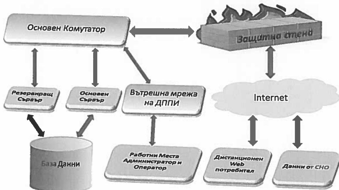
Архитектурата на системата е изградена на базата на два сървъра за работа на приложният софтуер и софтуера за базата данни. При отпадане на Основния сървър системата автоматично трябва да продължи работа на Резервиращия сървър без това да води до нейното спиране, прекъсване и загуба на данни.
