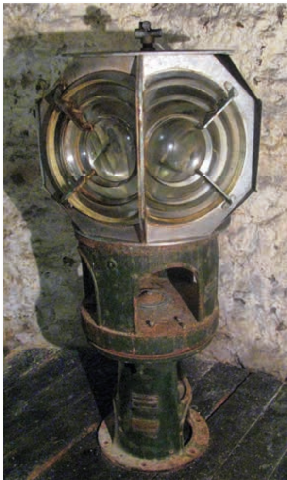
Оптиката на фара, произведена от шведската фирма AGA, от 30-те години на XX в., в действие до 1987 г. Снимка Мариана Кръстева
