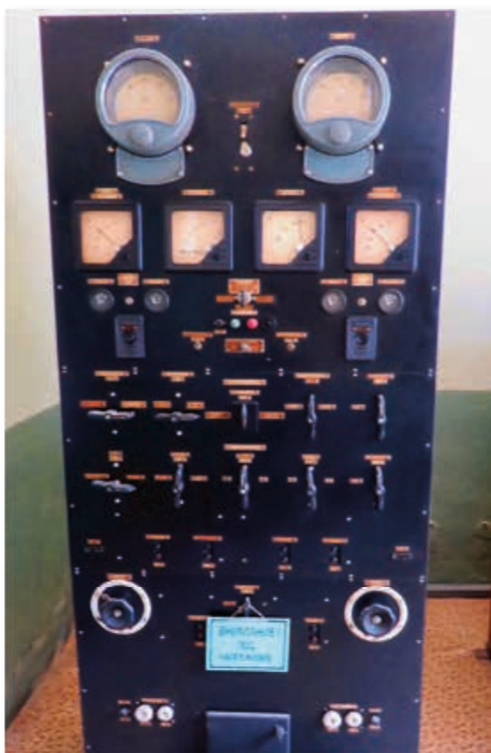
Единият от основните блокове с радиолампова апаратура на радиофар Маслен нос, 2016 г. Снимки Атанас Панайотов
